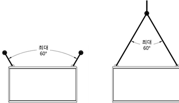
6. 실외에 설치 시 바람의 영향을 고려하여 설치하여야 합니다. 강풍의 영향에 의해 사전에 고려하였던 것 이상의 하중이 아이볼트에 가해질 수도 있고, 당겨지는 위치가 변경되어 스피커에 영향을 가할 수도 있습니다. 이러한 바람의 영향은 스피커의 크기가 커질수록 바람의 영향을 받는 면적이 더 커짐에 따라 더 강한 영향을 받게 됩니다.
