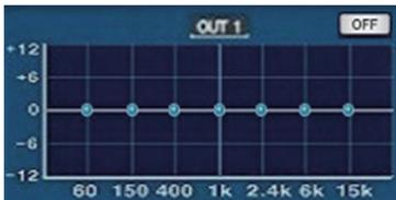
18. 7-BAND GEQ : 모든 출력 채널에 7-BAND GEQ를 내장하여 사용자가 원하는 음질의 소리 재생이 가능하며, +12dB 조절이 가능합니다. 또한, ON/OFF 버튼이 있어 사용자가 사용하기가 용이합니다.
