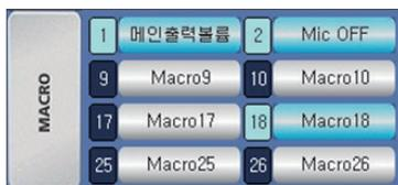
19. 매크로 스위치 : 사용자가 원하는 기능 및 동작 상태를 매크로 스위치에 저장하여 한 번의 동작으로 사용자가 원하는 동작을 수행하는 기능입니다. 최대 32 채널까지 가능합니다.
