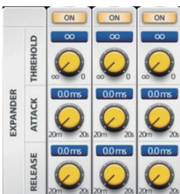
12. EXPANDER : 사용자가 THRESHOLD의 기준값을 이용하여 미약한 잔류신호를 제거하는 데 사용하며, 사용자가 깨끗한 음원을 만들기 위해 사용합니다. 또한, ON/OFF 스위치가 있어 사용자가 사용하기 용이합니다.
