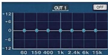
18. 7-BAND GEQ : 모든 출력 채널에 7-BAND GEQ를 내장하여 사용자가 원하는 음질의 소리 재생이 가능하며, +12dB 조절이 가능합니다. 또한, ON/OFF 버튼이 있어 사용자가 사용하기가 용이합니다.
