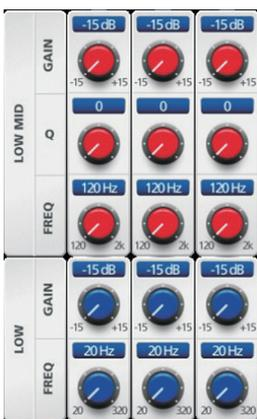
10. LOW-MID : PEQ의 LOW-MID 부분의 주파수 및 GAIN을 조정하는 부분으로 +15dB의 가변폭과 주파수 100Hz~2kHz 및 Q 값 조절 가능합니다.
