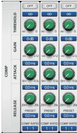
13. COMP : COMPRESSOR를 내장하여 과 입력 신호가 유입되었을 경우를 대비하여 장비의 오작동 및 고장을 미연에 방지가 가능합니다. 또한, ON/OFF 스위치가 있어 사용자가 사용하기 용이합니다.
